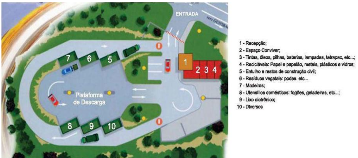
Figura 4: Estrutura geral de um “ecoponto” (Planta Modelo)
