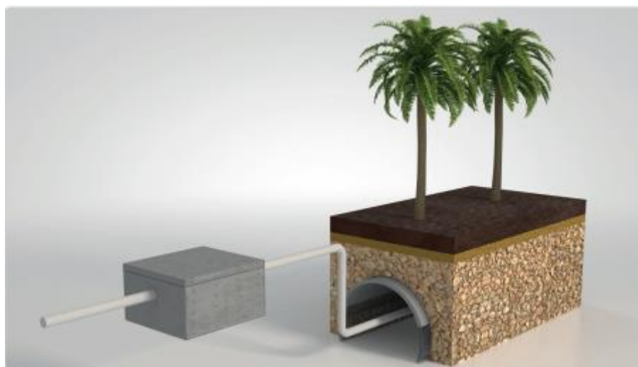
Figura 16: Tanque de evapotranspiração
