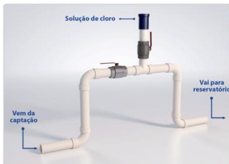
Figura 10: Esquema do Clorador Instalado na Tubulação
