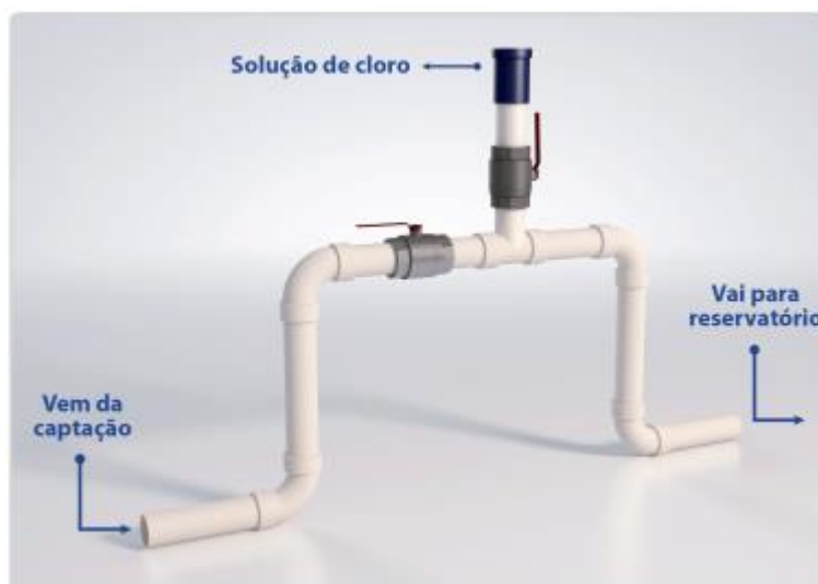
Figura 10: Esquema do Clorador Instalado na Tubulação
