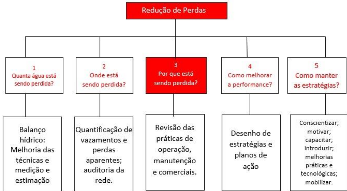
Figura 5: Requisitos para redução consistente das perdas nos sistemas de abastecimento.
