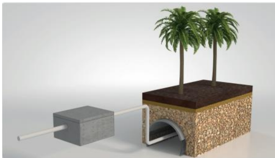
Figura 16: Tanque de evapotranspiração
